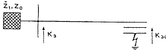
Figure 7. Configuration de base des défauts à la terre non utilisable pour des applications pratiques.
